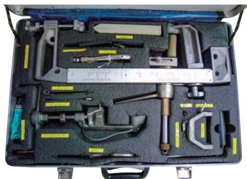
● Vスリーブの組立と解体に必要な工具のセットです
