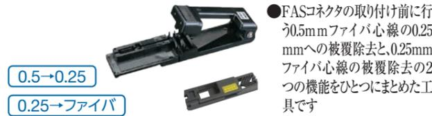
●FASコネクタの取り付け前に行う0.5mmファイバ心線の0.25mmへの被覆除去と、0.25mmファイバ心線の被覆除去の2つの機能をひとつにまとめた工具です
