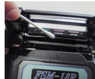
補強スリーブの未収縮を防ぐため、加熱器内部および、周辺に付着しているゴミや汚れを除去してください。
