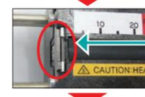
専用ブラシ(添付品)又は乾いた綿棒にて、被覆除去刃(上部・下部)に付着している被覆除去屑を取り除きます。
