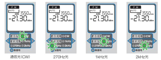
自動測定モードでは、上図の様に検出した光の種類に応じてLEDが点滅する。通信光検出時/“通信光(CW)”LEDが点滅する。変調光検出時/周波数に応じた“変調光”LEDが点滅し、測定値が表示される。
