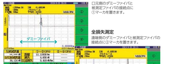
□元側のダミーファイバと被測定ファイバの接続点に①マーカを置きます。
