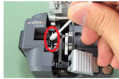
また、ピンチローラゴム面に、磨耗によって目視で確認できる程度の溝が発生しますが溝の深さが光ファイバの直径程度以下であれば、光ファイバの回収機能には支障をきたしません。ピンチローラを清掃しても光ファイバ屑の回収が困難な場合にはNTTRECに機器交換をご依頼ください。
