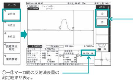
①-②マーカー間の反射減衰量の測定結果が表示。
