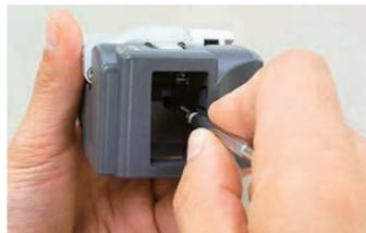
綿棒等を用いて切断刃の目盛の数字が大きくなる方向に一目盛まわします。
