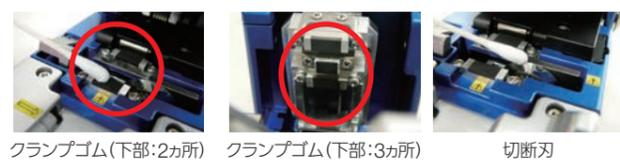
**注意!** 切断刃裏側(枠内)のプレート部は綿棒で清掃しないでください。動作不具合発生要因になります。(※詳しくは、P.203をご覧ください。)
