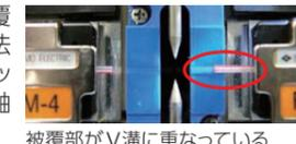
**POINT** 被覆除去後の被覆長が、規定寸法3mmであるか、確認しましょう。
