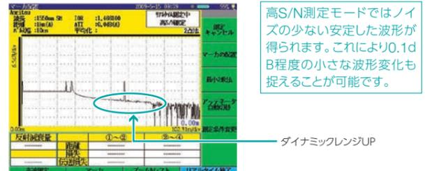
高S/N測定モードではノイズの少ない安定した波形が得られます。これにより0.1dB程度の小さな波形変化も捉えることが可能です。
