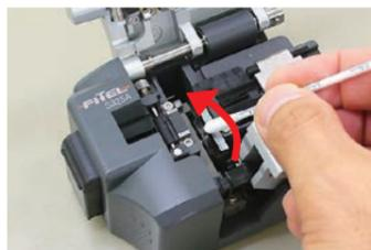
※切断刃の全周(24箇所)を使い切ったら切断刃を交換する必要があります。劣化をしている切断刃での切断は、融着接続時に光ファイバ端面不良でのエラーや端面の不揃いエラー、また接続の損失に支障をきたす原因になる場合があります。
