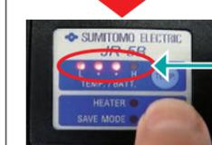
電源投入後、バッテリー残量が表示されます。
