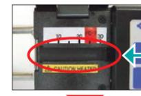
専用ブラシ(添付品)又は乾いた綿棒にて、加熱板に付着している被覆除去屑を取り除きます。
