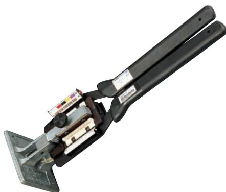
● AMP圧接結線方式の14,24,36,50極のチャンプ・コネクタを結線するために使用します
