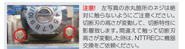
注意! 左写真の赤丸箇所のネジは絶対に触らないようにご注意ください。切断刃の高さが変動して、切断特性に影響致します。間違えて触って切断刃高さが変動した時は、NTTRECに機器交換をご依頼ください。
