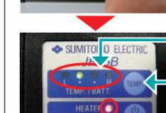
バッテリー残量表示後、標準設定温度(100度)に切り替わる。
