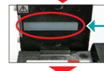
専用ブラシ(添付品)又は乾いた綿棒にて、被覆押さえゴムに付着している被覆除去屑を取り除きます。
