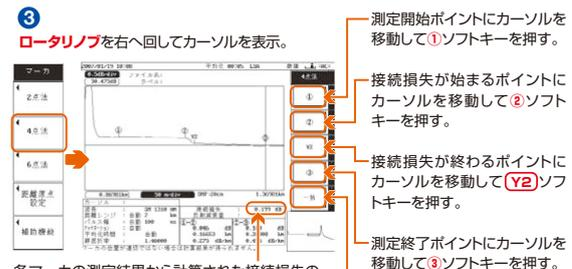
各マーカの測定結果から計算された接続損失の値が表示。
