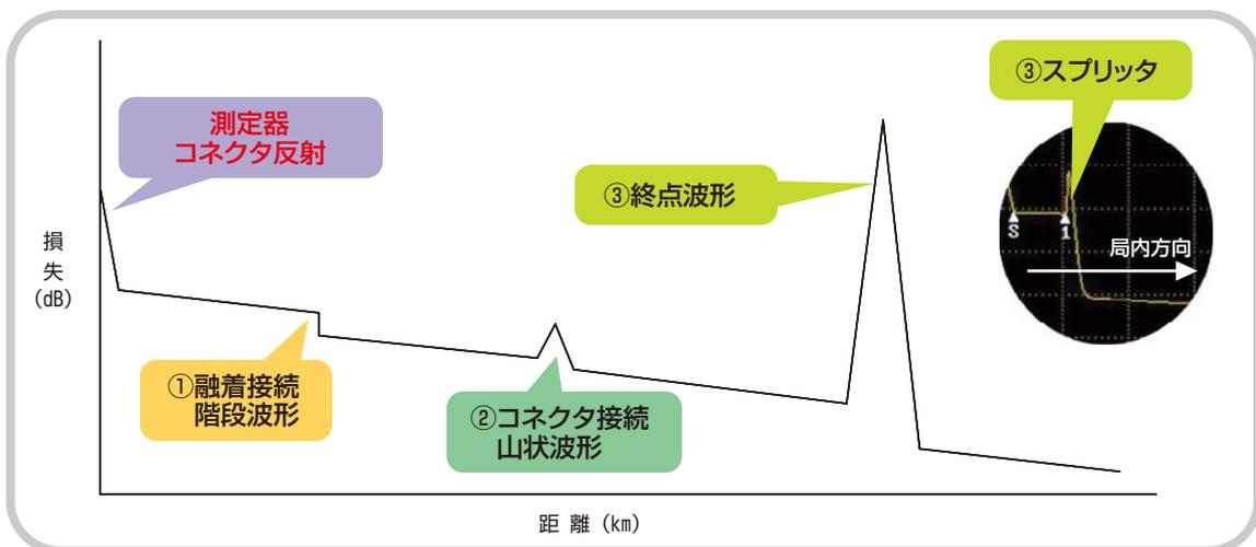
故障探査として宅内側よりOTDR測定し、光スプリッタを超えるOTDR波形を取得できる機種(PONシステム測定)もあります。
