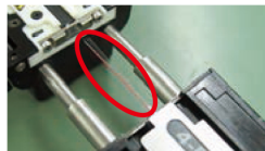
被覆の剥けが悪い状態
