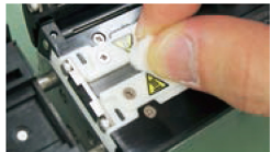
ヒーターの清掃
