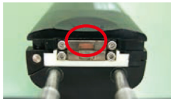
刃に錆が発生した状態
