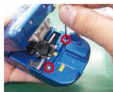
⑤ 切断刃の上部側を綿棒（柔らかい物）で押しながら、マイナスドライバを使い切断刃を止めているネジを締めてください。
