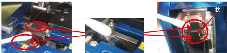
エチルアルコールを浸した綿棒で切断刃のエッジ部に付いたゴミおよびファイバ屑をきれいに拭き取ります。
