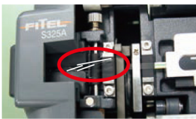
クランプゴム上に残った光ファイバ屑
