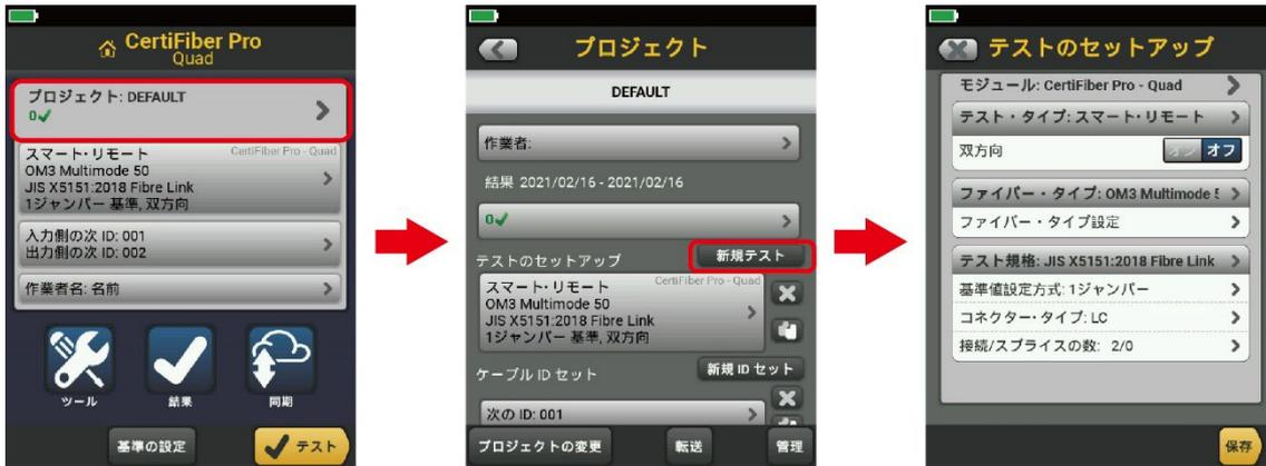
重要な項目としては測定対象の“ファイバー・タイプ”（OM2, OM3 など）と合否判定に利用する“テスト規格”（TIA や ISO、JIS など）です。その他の設定としては“基準値設定方法”で“1 ジャンパー”を選択した場合は、“接続/スプライスの数”の接続の数は、基本的には“2”と設定します。両端だけではなく、途中で中継のコネクタを介しているのであれば、その数を追加します。
