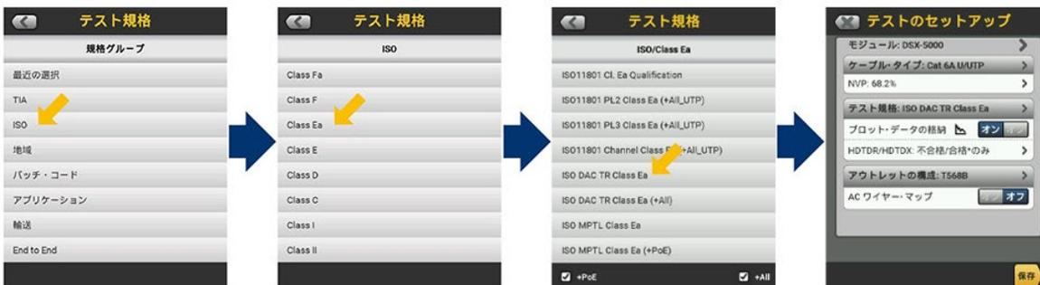
MPTL (モジュラ・プラグ終端リンク) は、一方の端に相互接続 (モジュラ・ジャック)、もう一方の端にモジュラ・プラグがあり、一方の端はパーマネント・リンク・アダプターを使用してテストされ、もう一方の端はパッチ・コード・アダプターを使用してテストされます。MPTL は、LED 照明、セキュリティ、ワイヤレス・アクセス・ポイントなど、パッチ・コードが不要または利用が難しいアプリケーションで使用されます。
