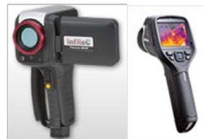
赤外線サーモグラフィ
